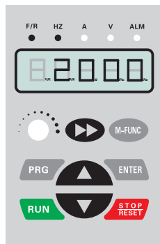
图1-4 运行参数显示状态 显示运行时输出频率 “20.00”
